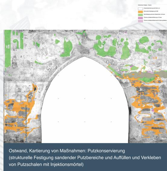
Ostwand, Kartierung von Maßnahmen: Putzkonservierung (strukturelle Festigung sandender Putzbereiche und Auffüllen und Verkleben von Putzschalen mit Injektionsmörtel)
