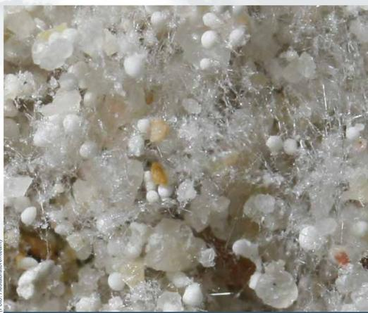
Auskristallisierte Salze auf der Kompressen in Form von Nadelspitzen. Die Bildunterkante entspricht 1 cm
