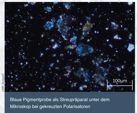
Blau Pigmentprobe als Streupräparat unter dem Mikroskop bei gekreuzten Polarisatoren
